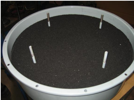
Suodattimen alaosassa on hiiltä.
