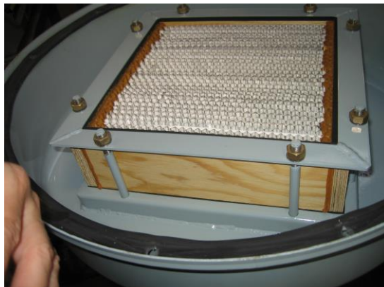
Suodattimen yläosassa on hiukkassuodatin.
