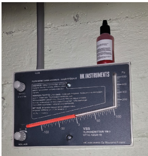
Kuva 99 ja 100. Ylipainemittari ja varanestepullo.
