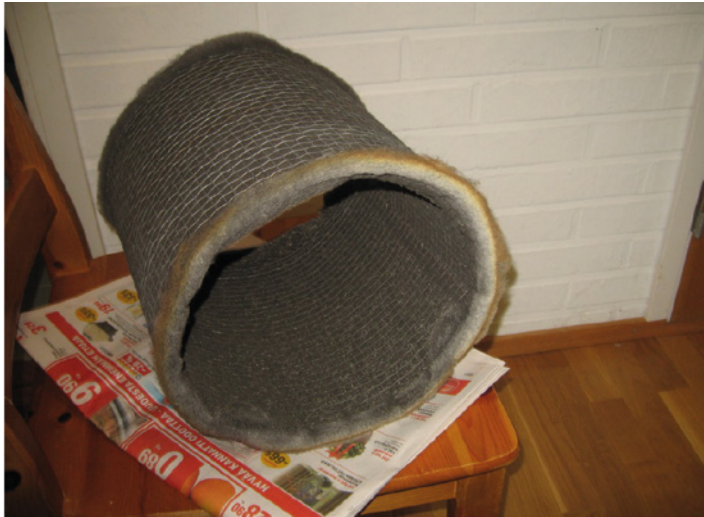
Kuvat 75 ja 76. Esisuodattimista toinen on täysin tuhoutunut ja toinen puhdas.
