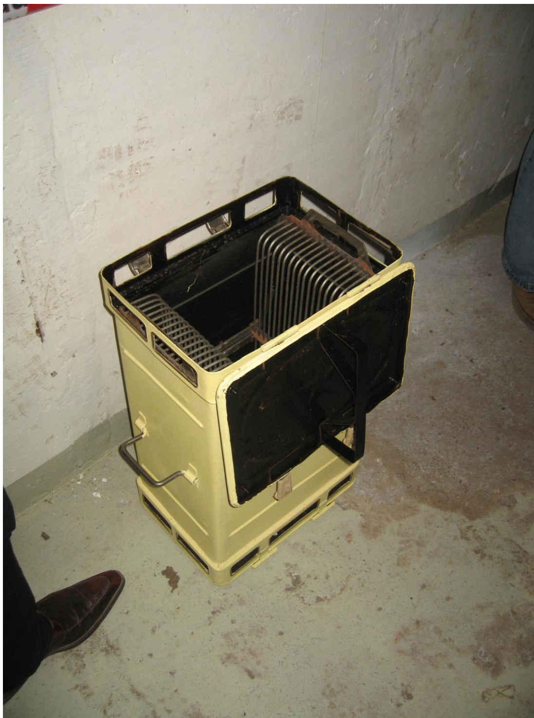
Kuvassa oleva laite tuotti happea 4 hengelle vuorokauden ajan.
